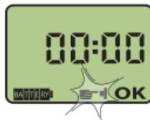
Wenn ca. 5 Minuten lang keine Taste gedrückt wird, geht der Bewässerungscomputer automatisch zur Seite Uhrzeit und Tag, ohne die Änderung, die in Gang war, zu bestätigen.
