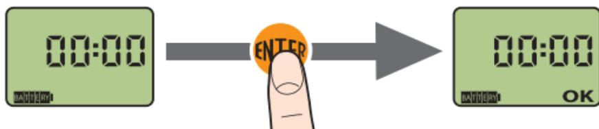
Wenn die Schrift **OK** leuchtet, kann mit den Tasten ◀ und ▶ der angezeigte Parameterwert geändert werden.
